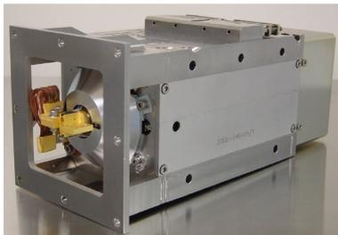
Fig 1.2 : Un réfrigérateur à adsorption pour Herschel
