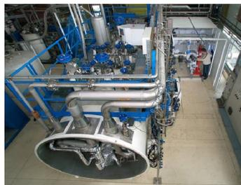
Figure 3.4 : l'expérience « Cryoloop » couplée au réfrigérateur 1,8 K du SBT
