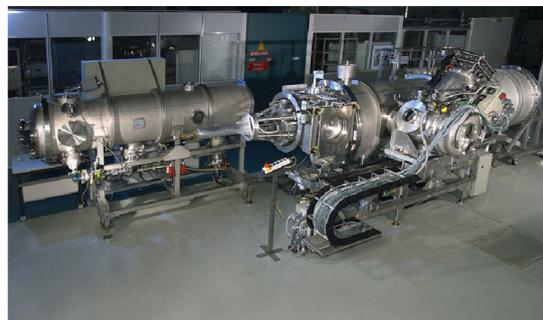
Figure 2.2 : le prototype du bras cryogénique qui positionnera la cible, en test au SBT
