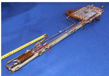
Figure 1.6: la boucle à pompage capillaire réalisée au SBT
