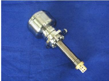
Fig 1.1 : Un tube à gaz pulsé, le LPTC
