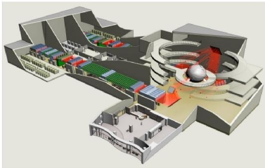
Figure 2.1 : une vue du LMJ : au centre la chambre, dans laquelle on introduit deux bras cryogéniques l'un pour supporter la cible, l'autre pour enlever l'écran de celle-ci avant le tir.
