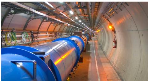
Figure 3.3 : le LHC : un anneau de 27 km avec 1700 aimants refroidis à l'hélium superfluide à 1,9 K
